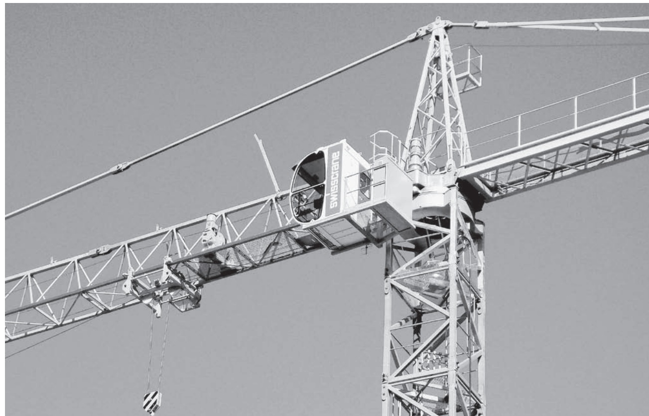
Dieser Kran spart Energie beim Bauen: Er erzeugt Strom, wenn er seine Last abbremst – ähnlich wie ein Hybridauto.
